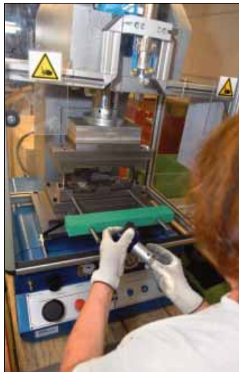
Een hydropneumatische pers vergt minder onderhoud dan een excenterpers
