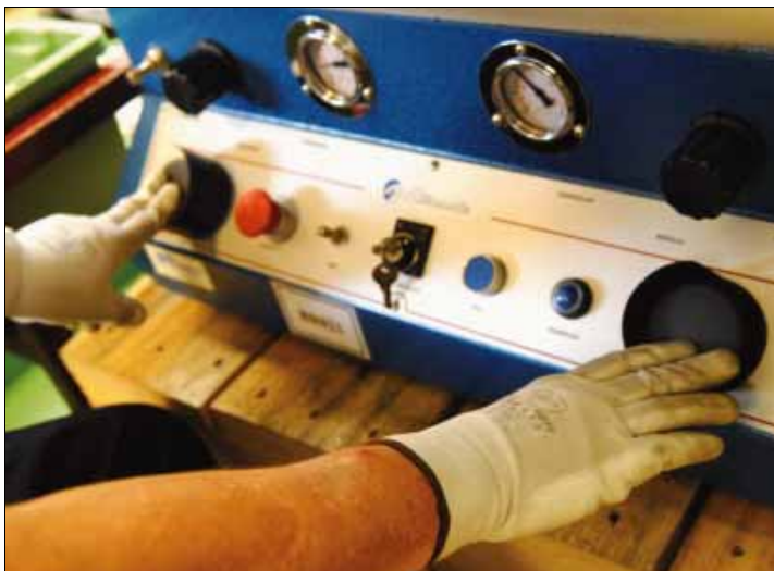
Er is gekozen voor een hydropneumatische pers van 21 ton die voorzien is van een veiligheidstweehandsbediening
