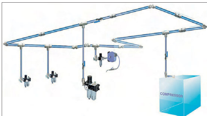
Een netwerk in ringvorm biedt het voordeel dat de toevoer van perslucht vanuit twee richtingen gebeurt
