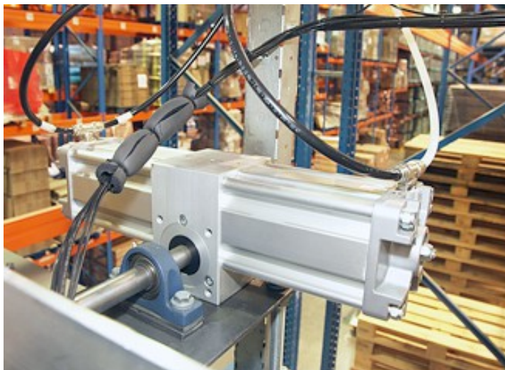
De kantelaar wordt aangedreven door een pneumatische draaicilinder
