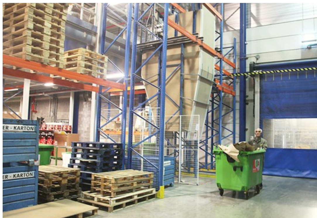
Rolcontainers en een kantelaar vervangen de heftrucks, transpalletten en ijzeren containers (blauwe bakken links op de foto)
