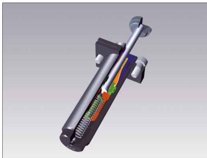
Les amortisseurs industriels sont constitués d'une tige entraînant un piston trempé et déplaçant un fluide
