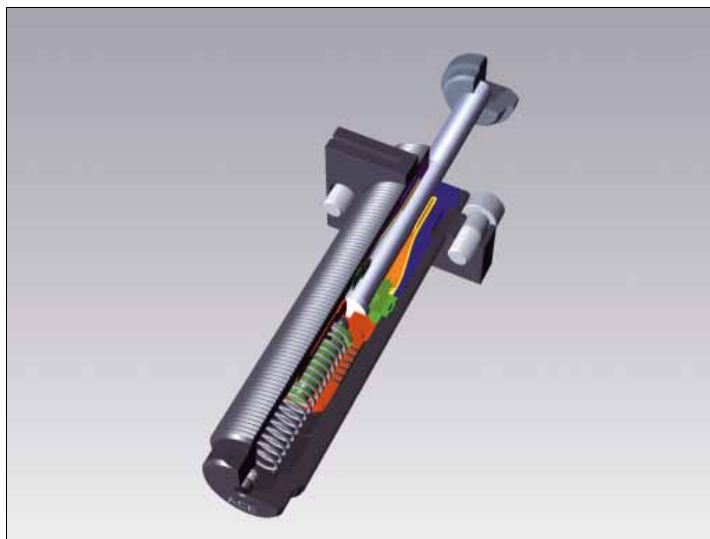
Industriële stootdempers bestaan uit een stang die een geharde zuiger aandrijft en vloeistof verplaatst
