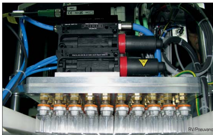
La pince dépose ensuite les flacons sur la bande d'alimentation à l'entrée de la ligne d'emballage.
