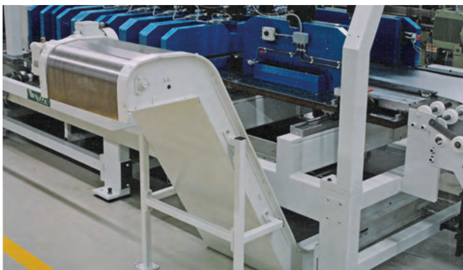
Convoyeurs à glissières montés sous une presse, pour l'évacuation des résidus de presse.
