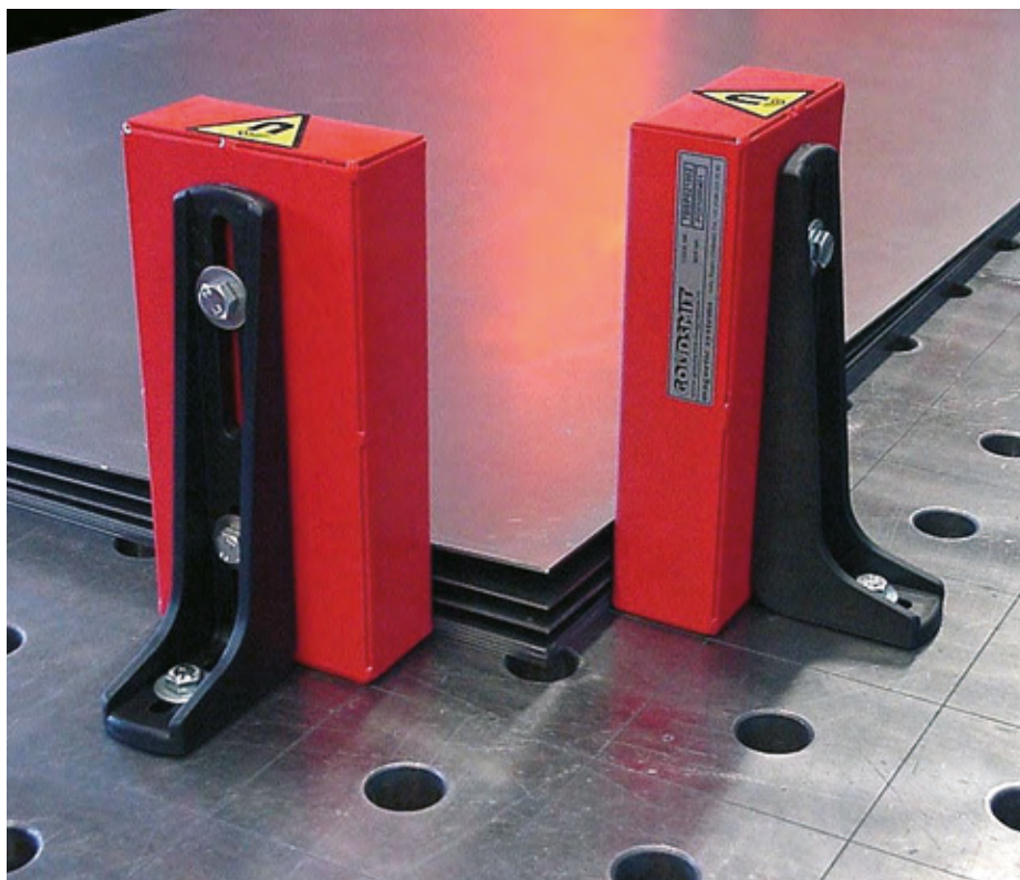
Séparateurs de tôles permanents et non commutables en version ferrite ou néodyme ; le néodyme est 30% plus puissant et convient aux tôles avec très huilées dans un espace limité.
