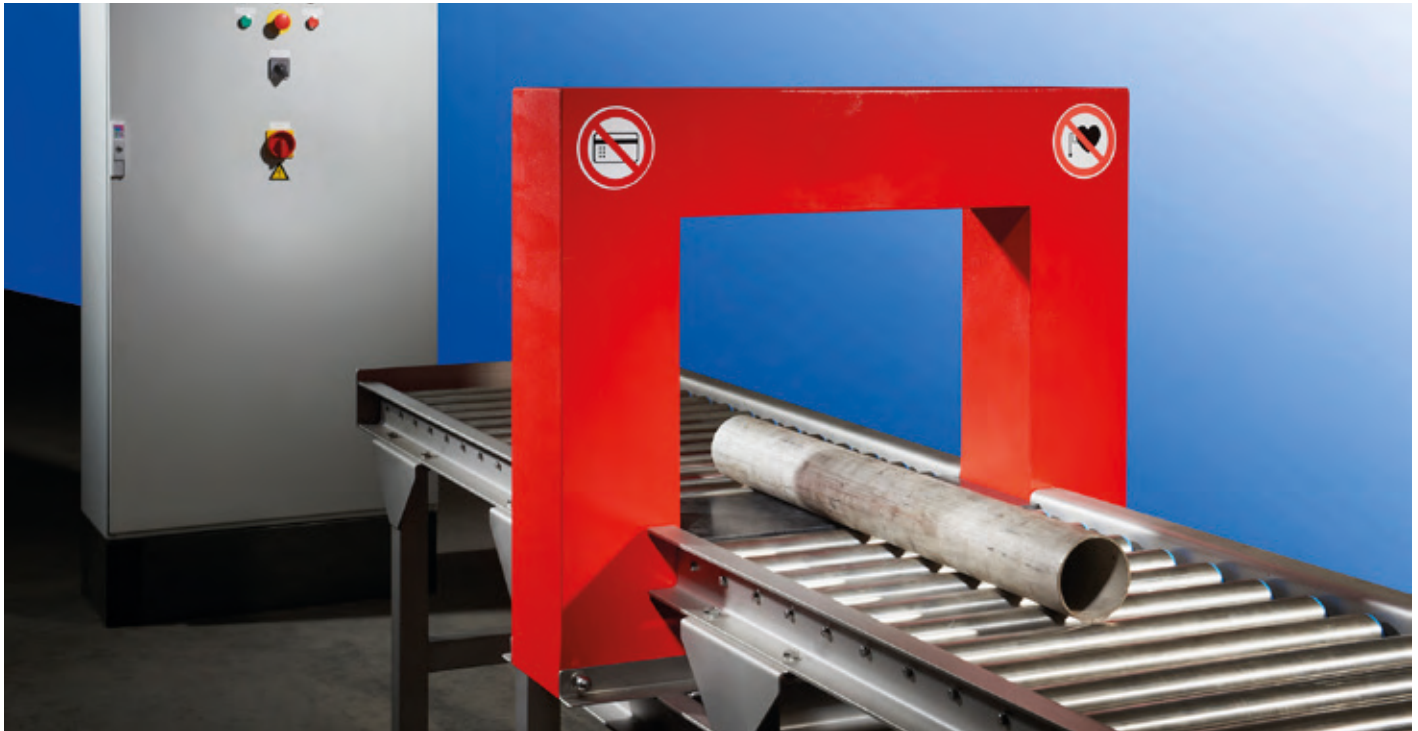
Les systèmes de démagnétisation Goudsmit éliminent le magnétisme indésirable pendant ou après les processus d'usinage. Outre des équipements, nous pouvons vous proposer une prestation de démagnétisation sur site.
