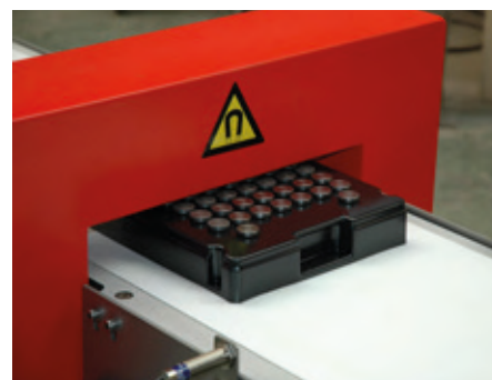
Goudsmits demagnetiseersystemen verwijderen ongewenst magnetisme tijdens of na bewerkingsprocessen. Naast de verschillende systemen, is het ook mogelijk bij u op locatie te demagnetiseren.
