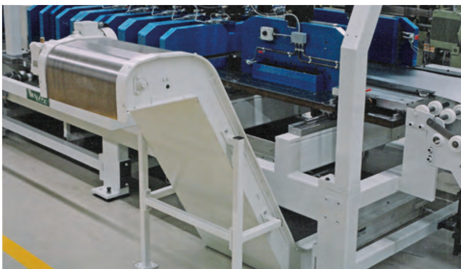
Slide conveyors gemonteerd onder een persmachine, voor het afvoeren van persresten.
